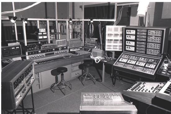
Développée pour le Gmebaphone, la matrice programmable dite C6 en sorte de mémoriser des tableaux de connexions, des tablatures propres à établir immédiatement des figures de diffusion, le nombre et l'emplacement des HP. Les critères de masse, de fortissimo, de pianissimi, de solo, de tutti deviennent jouables instantanément ainsi que les oppositions ou les regroupements des réseaux V et des Références sont immédiats.
